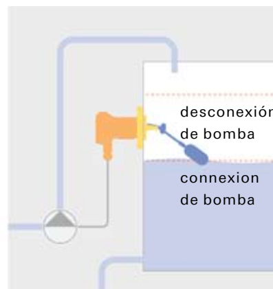
control de bombas y válvulas
