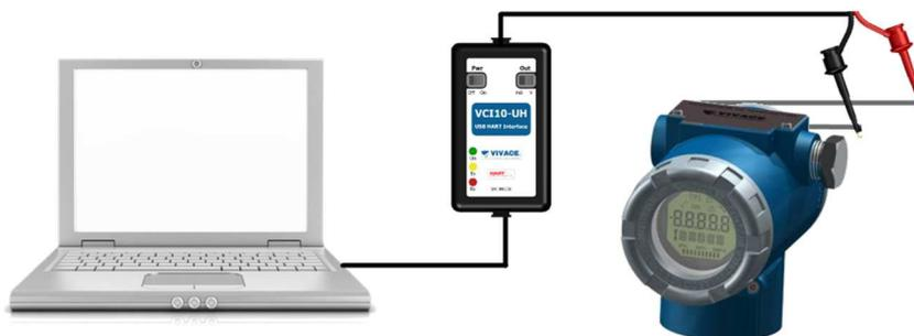
Figura 3.6 - Esquema de conexión de la interfaz VCI10-UH alimentando el VTT10-FH.
