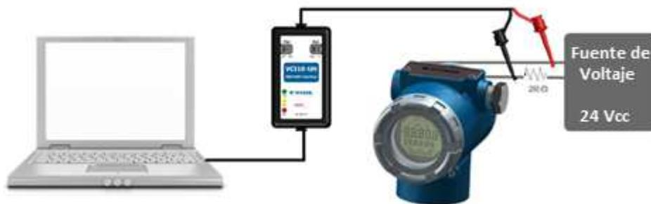
Figura 3.5 - Esquema de conexión de la interfaz VCI10-UH al VTT10-FH con alimentación externa.
